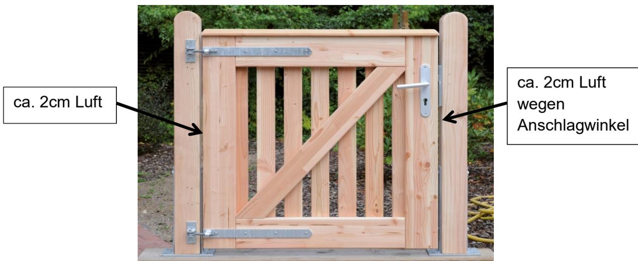
Die Hespaken am Türpfosten so ausrichten, dass die Hespakenplatte bündig mit dem Pfosten abschließt. Danach die Hespakenplatte mit je 4 Stück 5x50mm Spaxschrauben befestigen.
