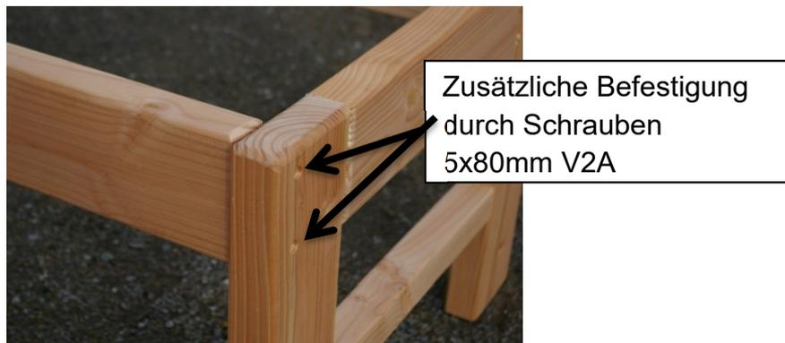
Nun wird das Mittelteil (B) der Sitzbank mit Lehne mittig ausgerichtet und vorne und hinten mit jeweils 2 Stück ASSY-Schrauben 5x80mm V2A (H) befestigt (Löcher sind vorgebohrt).
