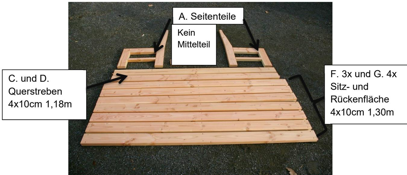
Als erstes stecken Sie die Holzdübel (E) in die vorgebohrten Löcher der Querstreben (C und D). Geben Sie vorher ein wenig Leim in die Löcher. Stellen Sie ein Seitenteil (A) ebenerdig auf und verbinden Sie diese mit der vorderen Querstrebe (D). Dazu setzen Sie die Querstrebe mit dem Dübel (D) in das vorgebohrte Loch des Seitenteils (A) ein. Fügen Sie vorher wieder Leim hinzu. Die Rundungen müssen nach oben zeigen.
