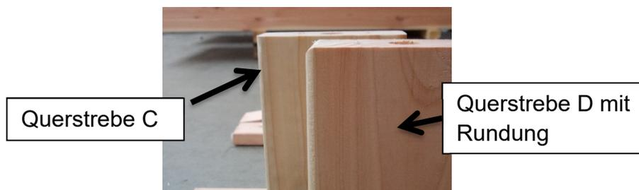
Als nächstes wird die hintere Querstrebe (C) mit dem Seitenteil (A) verbunden. Dazu setzen Sie die Querstrebe mit dem Dübel (C) in das vorgebohrte Loch des Seitenteils (A) ein. Fügen Sie vorher wieder Leim hinzu.
