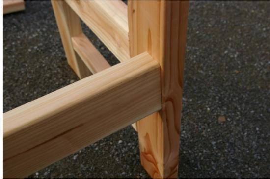
Das andere Seitenteil (A) wird mit den Querstreben verbunden. Setzen Sie wie zuvor die Querstreben (C und D) mit dem Seitenteil (A) zusammen.
