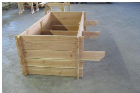
Um das Hochbeet weiter zu stabilisieren werden die 2 Stück Mittelstreben (2,8x14,5x63cm) an den Längsseiten mit je 10 Schrauben (5x50mm Assy) befestigt. Pro waagerechte Bohle werden je 2 Schrauben zur Befestigung verwendet.
