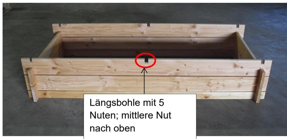
Jetzt werden die 3 Stück Querbohlen (2,8x14,5x129,5/122,5cm mit 4 Nuten und Schräge) benötigt. Diese werden wie die vorherigen Querbohlen, an beiden Seiten und in der Mitte in die Nut gesetzt. Die Schrägen sollten jeweils nach unten und zur gleichen Seite zeigen.
