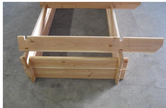
Die 2 Stück Längsbohlen (2,8x14,5x199,5cm mit 5 Nuten) werden als nächstes eingesetzt. Dabei ist darauf zu achten, dass die mittlere Nut nach unten zeigt.
