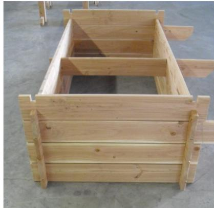
An den Seiten kommen nun die letzten Querbohlen (2,8x7x99,5cm mit 2 Nuten). Diese werden mit der Nut nach unten in die anderen Nuten eingesetzt.
