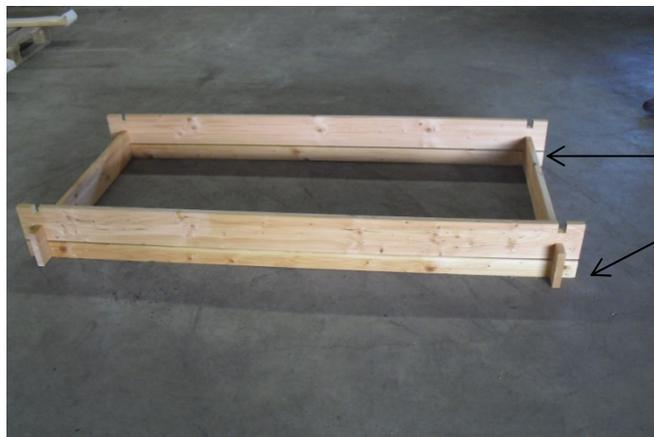
Es folgen wieder 2 Querbohlen (2,8x14,5x99,5cm mit 4 Nuten) diese werden wie zuvor in die Nuten eingesetzt.
