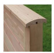
Hierzu muss die oberste Jütland Bohle ca. 10mm über die Pfostenoberkante überstehen. Die Abdeckbohle hat eine Länge von 225cm und muss angepasst werden. Zum Festschrauben eignen sich Edelstahlschrauben 4,5x60mm (Vorbohren!).
