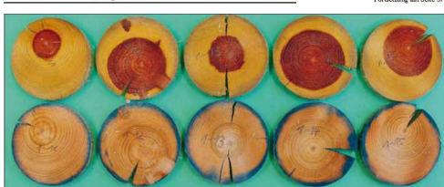
Bild 6: Repräsentative Querschnitte von fünf Pfählen aus dem Baumarkt mit klar verliehener Penetrationsklasse NPS; obere Querschnitte mit roter Kernholzanfärbung und untere Querschnitte mit blauer Kupferanfarbung. Das Splintholz ist nur marginal vom Schutzmittel getränkt.
