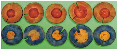
Bild 7: Repräsentative Querschnitte von fünf Pfählen aus dem Fachmarkt mit erfüllter Penetrationsklasse NPS; obere Querschnitte mit roter Kernholzanfärbung und untere Querschnitte mit blauer Kupferanfarbung. Das Splintholz ist vollständig vom Schutzmittel durchtränkt.
