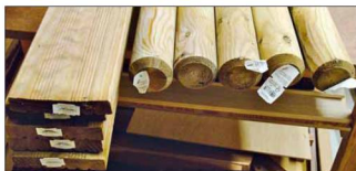
Bild 2: Terrassendielen und Holzpfähle für die Untersuchungen
