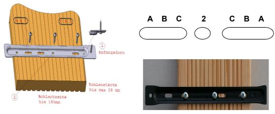
Die beiden äußeren Schrauben (5x17mm) werden in die Langlöcher geschraubt. **Diese beiden Schrauben dürfen nur leicht angezogen werden**, damit die Schraubenköpfe sich beim Quellen oder Schrumpfen des Holzes in den Langlöchern bewegen können. Können sie dies nicht, kommt es zum Reißen des Holzes. Jede Gewährleistung ist dann ausgeschlossen.
